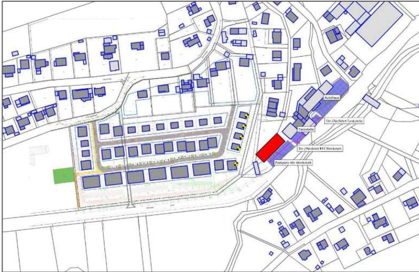
Abbildung 4: Auszug aus dem Berechnungsmodell nach TA Lärm [15]
